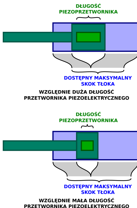
Rysunek 3.1. Ograniczenie skoku tłoka spowodowane zastosowaniem zaworu ze względnie długim przetwornikiem piezoelektrycznym
